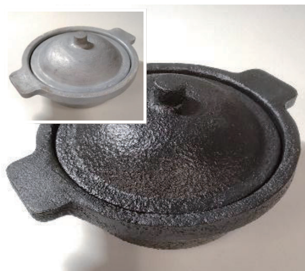
3Dプリンターで作成した模型（上） 下は塗装後の実物鋳物（下）
