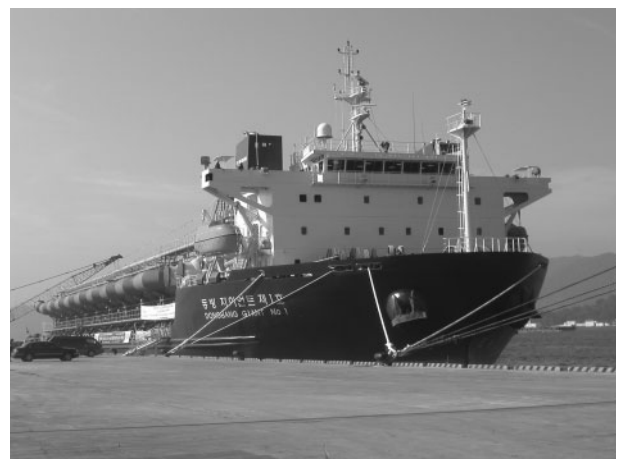
DONG BANG GIANT No.1 韓国で建造されたLH41L形主機関2基搭載した 11,000dwt貨物船
