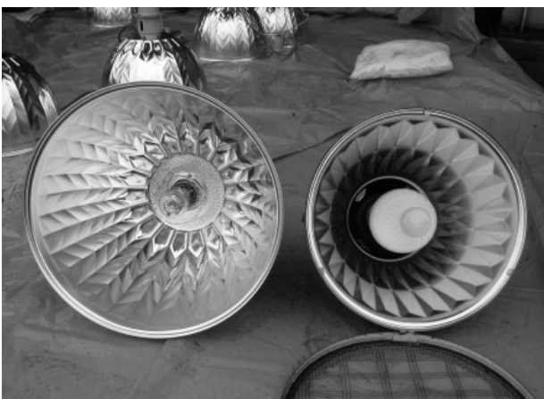
左側：メタルハライドランプ、右側が水銀ランプ
