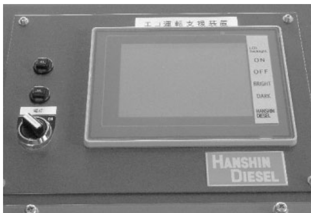
操舵室操縦盤組み込み状態
