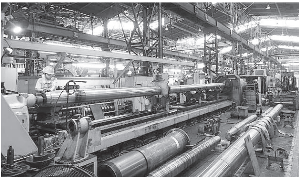
写真：L-505 × 11mプロペラ軸
