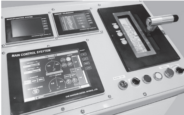
図1. 操舵室操縦盤
